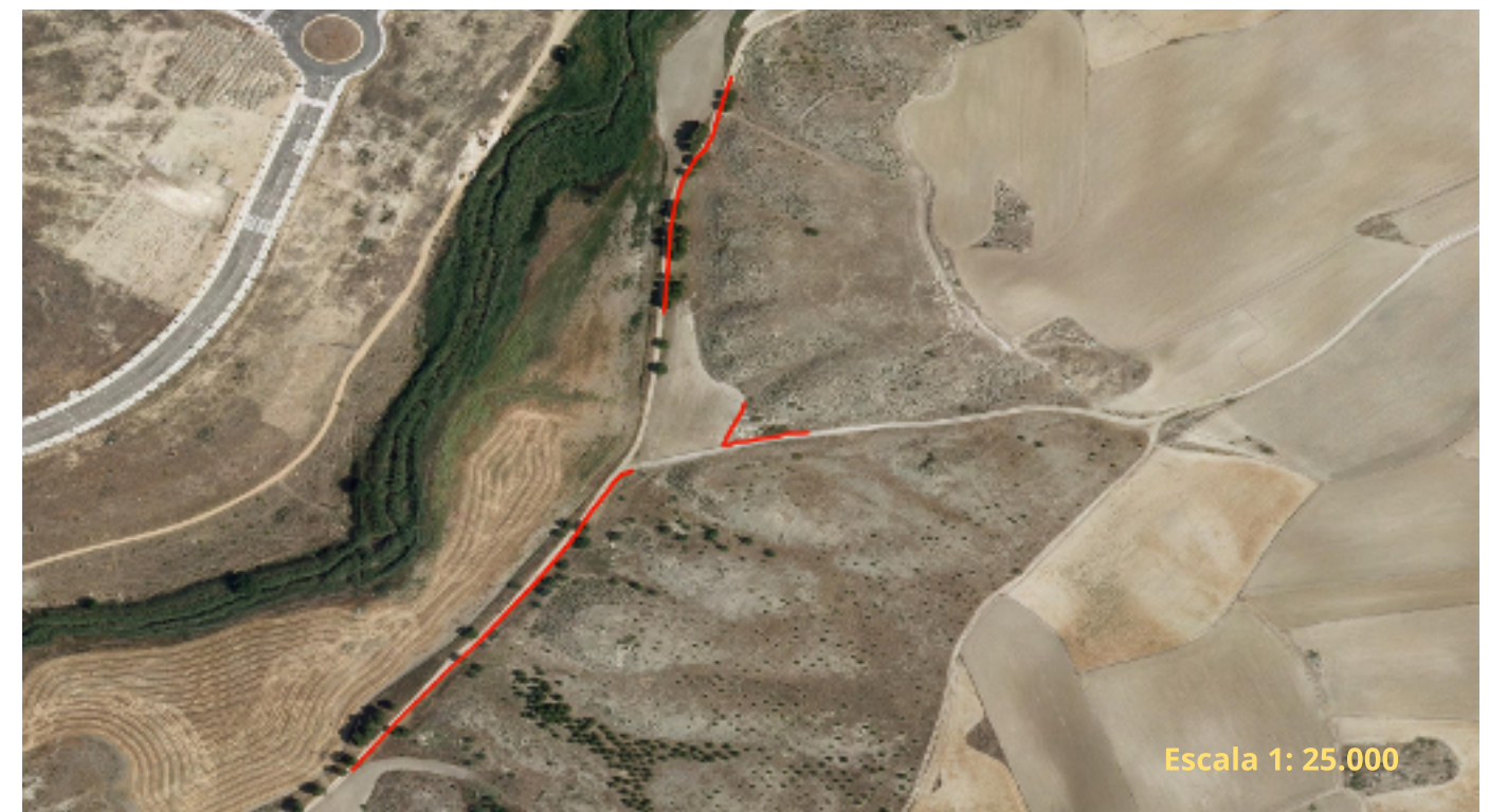
Propuesta de trazados para la instalación de bionda que proteja las comunidades de yesos más consolidadas, de forma compatible con el uso público.
