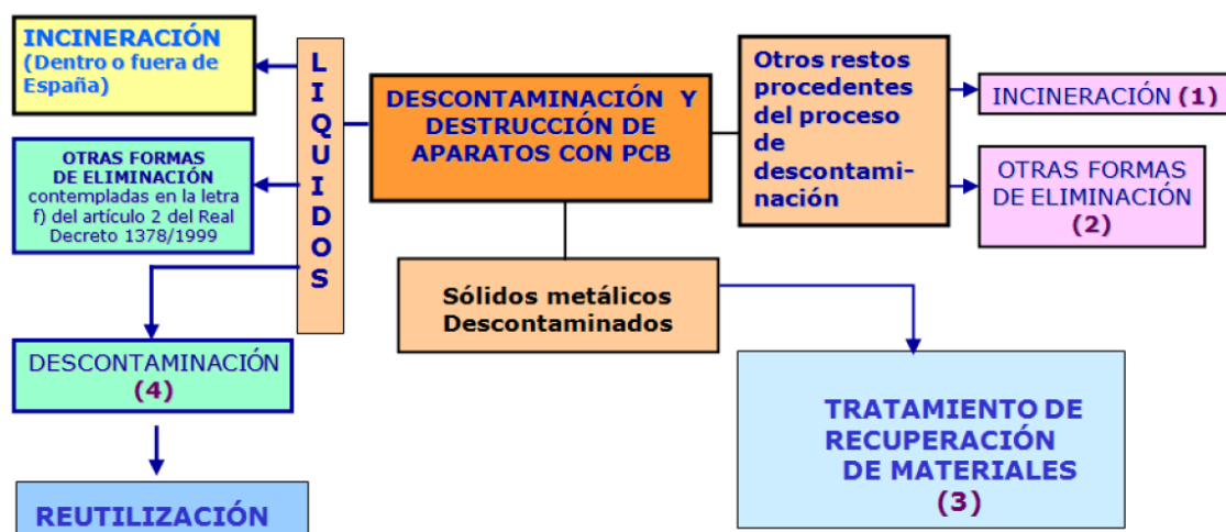
Proceso de tratamiento de aparatos con PCB
